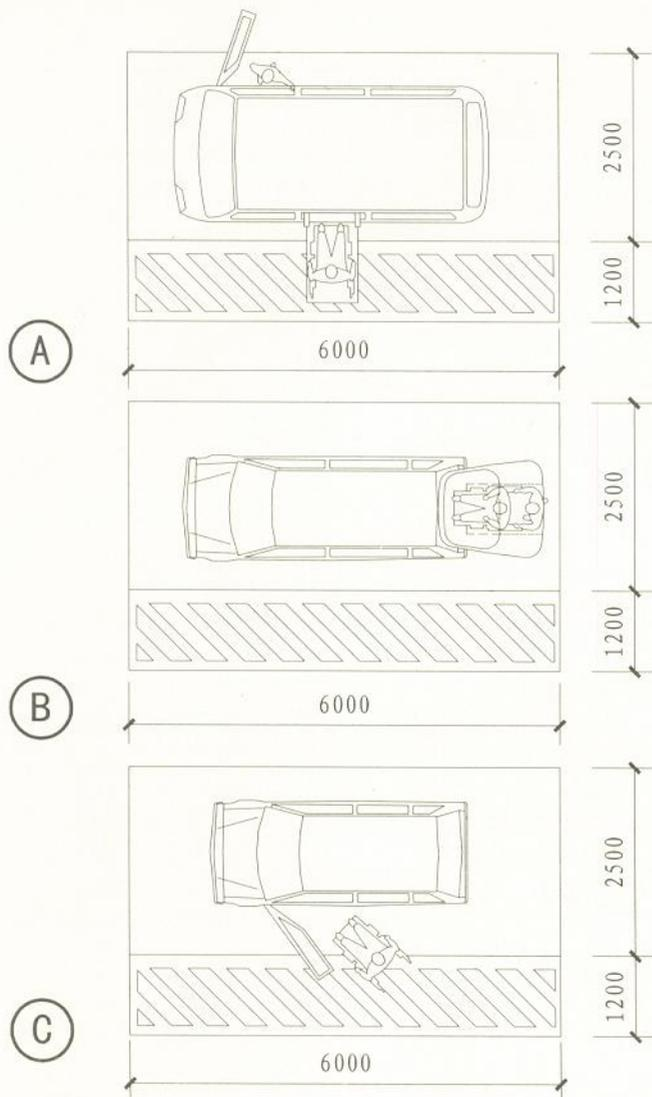
注: 1. (A) (B) (C)为不同规格的无障碍车型, 停车位应设在距建筑入口最近位置, 并设有无障碍标志。
