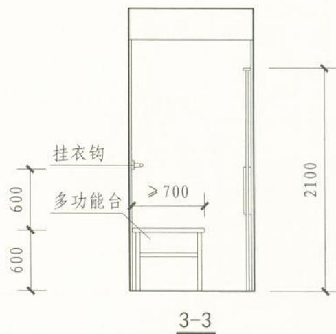
注: ②型厕位门扇为推拉门开启后净宽 $>800$ , 但厕位宽度小, 轮椅进入后不能旋转, 只能倒退出来。设坐便器、安全抓杆、多功能台、挂衣钩等。
