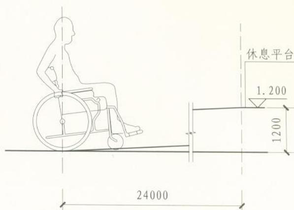
③ 1:20坡道最大高度及水平长度
