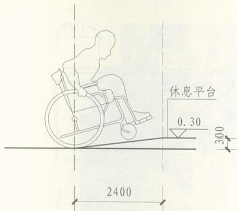
① 1:8坡道最大高度及水平长度
