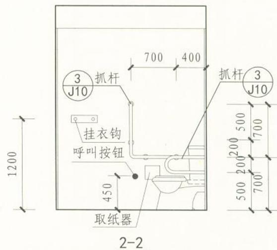
注：①型厕位门扇为推拉门开启后净宽 $\geq 800$ ，但厕位宽度小，轮椅进入后可旋转 $360^\circ$ 。内设坐便器、安全抓杆、多功能台、挂衣钩等。
