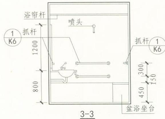
注: ②、③型客房、病房无障碍盆浴间门扇开启净宽 $\geq 800$ , 设坐便器、安全抓杆、台式手盆、洗浴坐台、呼叫按钮等。
