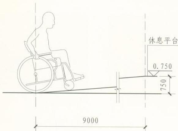
② 1:12坡道最大高度及水平长度
