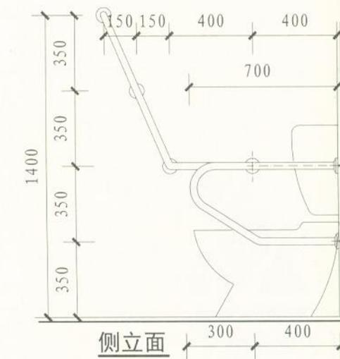
注：安全抓杆应安装牢固，直径应为30~40，内侧距墙不应小于40。
