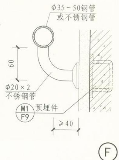
注：1. (B)(E)为扶手安装在普通砖墙或填充墙上的做法。
